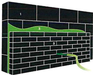
1. Dragende muur | 2. Ingeblazen isolatie | 3. Gevelsteen / gevelbekleding
